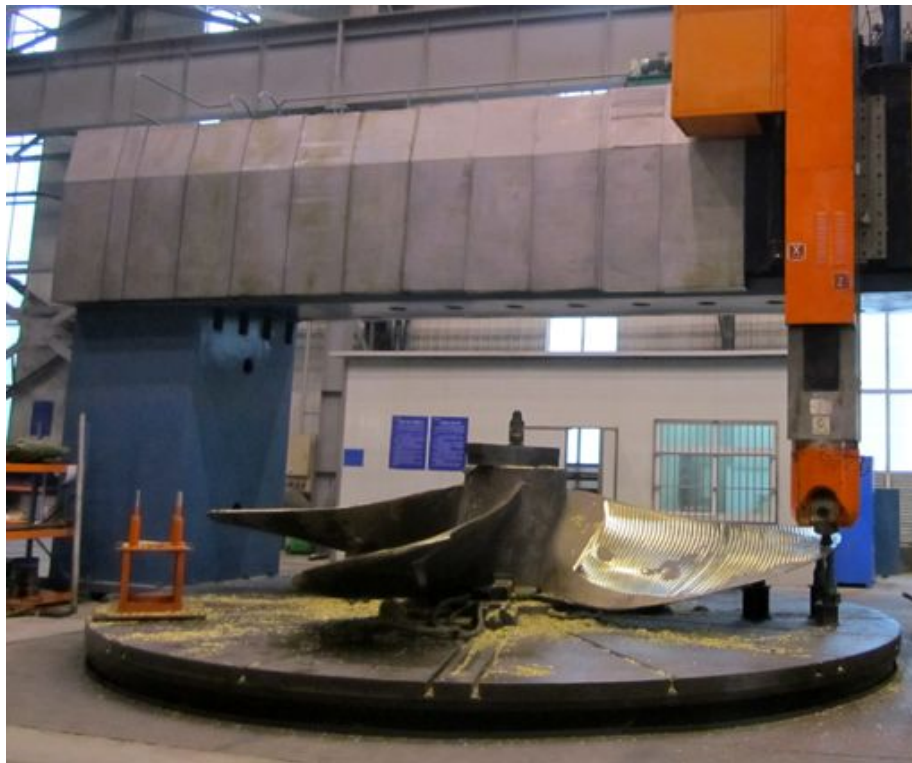
CKX5680 型螺旋桨用重型七轴五联动车铣复合机床
